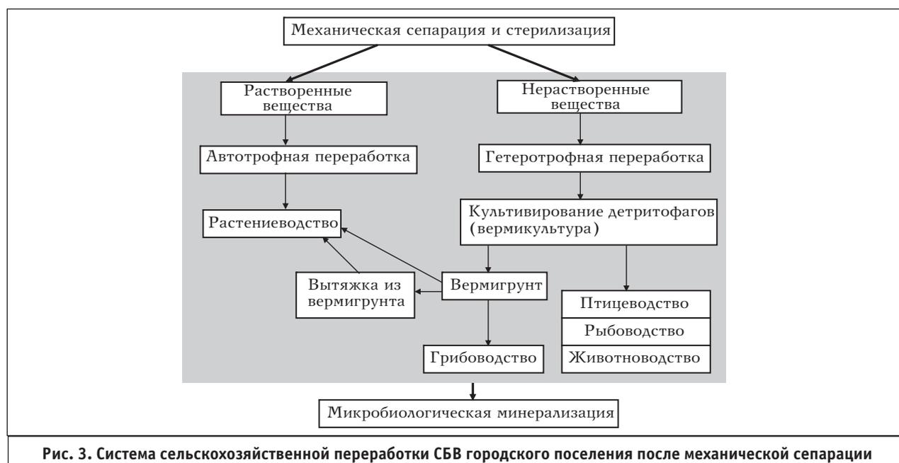
Рис. 3. Система сельскохозяйственной переработки СБВ городского поселения после механической сепарации
